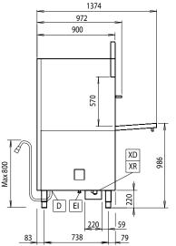
D Scarico acqua FΙ Connessione elettrica EO Presea elettrica Attacco acqua calda Ingresso acqua
